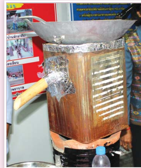
ภาพที่ ๒๕ การสกัดน้ำมันตะไคร้หอม
